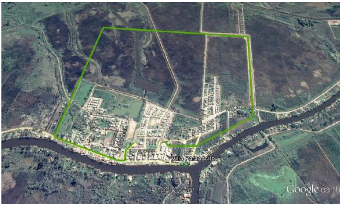
Trazado del terraplén de defensa a diseñar
